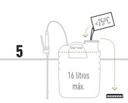
Encha o depósito com o líquido a pulverizar até à marca do nível pretendido. A temperatura do líquido não deve exceder os 25°C.
