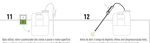
Apos utuzar, retre o putverizador das costas e pouse-o numa superricie plana e estável, coloque o botão de energia na posição "O" (Desligado).
