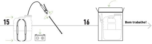
Antes de armazenar, carregue a bateria, desaperte a cana, a mangueira e retire as alças de transporte para facilitar o encaixe na caixa de cartão.
