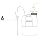
Coloque novamente a tampa do depósito e aperte bem. Verifique sempre se a tampa fica bem instalada para evitar fugas.
