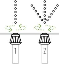
Para ajustar o fluxo de pulverização rode o bico da cana. Rode para a direita para função jato (1), rode para a esquerda para função chuva (2).
