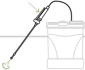
Antes de abrir a tampa do depósito, efetue uma depressurização total, pressione o gatilho até sair toda a pressão do depósito.
