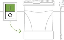
Para que o depósito ganhe pressão, coloque o botão de energia na posição "I" (Ligado). Coloque o pulverizador nas costas e agarre o punho.
