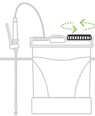
Coloque novamente a tampa do depósito e aperte bem. Verifique sempre se a tampa fica bem instalada para evitar fugas.
