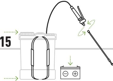
Antes de armazenar, carregue a bateria, desaperte a cana, a mangueira e retire as alças de transporte para facilitar o encaixe na caixa de cartão.
