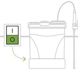
Após utilizar, retire o pulverizador das costas e pouso-o numa superfície plana e estável, coloque o botão de energia na posição "O" (Desligado).
