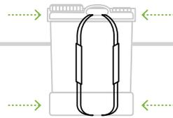
Instale as alças de transporte do pulverizador, procure os orifícios de encaixe e fixe corretamente as alças. Experimente antes de trabalhar.
