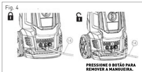
Fixe uma extremidade da mangueira de alta pressão à saída de água sob alta pressão da máquina
