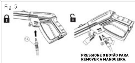
Nota: Após conectar a mangueira de alta pressão, verifique a conexão puxando suavemente a mangueira para garantir que permaneça fixa. Pressione o botão de bloqueio e puxe para desencaixar a mangueira de alta pressão.
